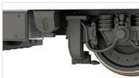
Versterkt ontwerp van de zandafvoerpijpen
