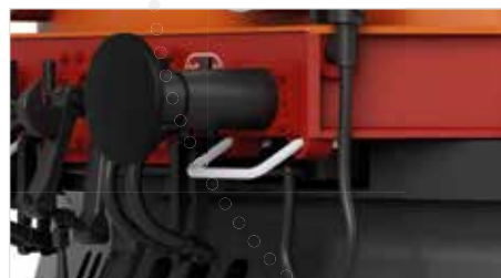
Bufferbalk met vrijstaande handgrepen en verwarmingskabel
