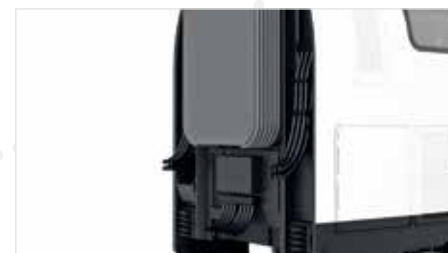
Reproductie van de kabels tussen de wagons
