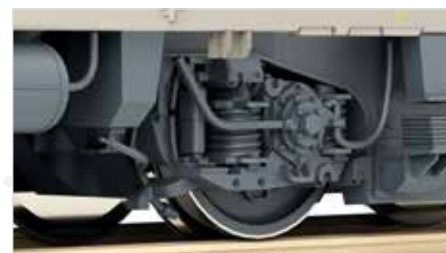
Ontwerp van de draaistellen gemodelleerd naar de BB 15000
